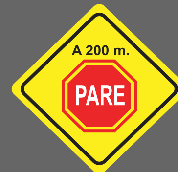
PROXIMIDAD DE SEÑAL RESTRICTIVA (pare)
